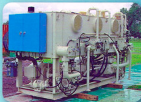
Unidades de Potencia con Blocks Manifoulds limitando las tuberías, de fácil acceso y mantenimiento con equipos hidráulicos más comerciales.
